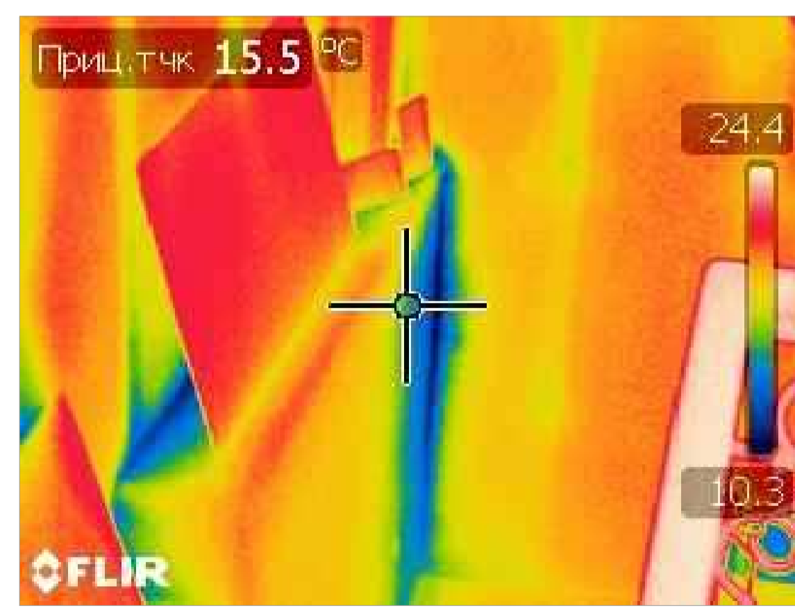
Результаты тепловизионной съемки угла мансарды при t н = -22 °C.
