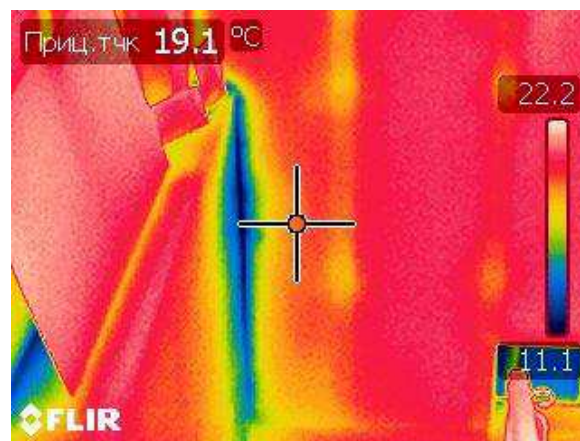
Рисунок 23 – Термограмма внутренней поверхности при t_n = -22^\circ\text{C} после утепления.
