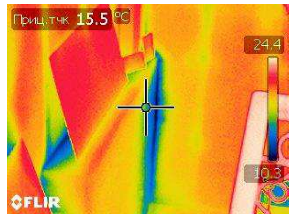
Рисунок 17 – Термограмма узла внутри помещения.
