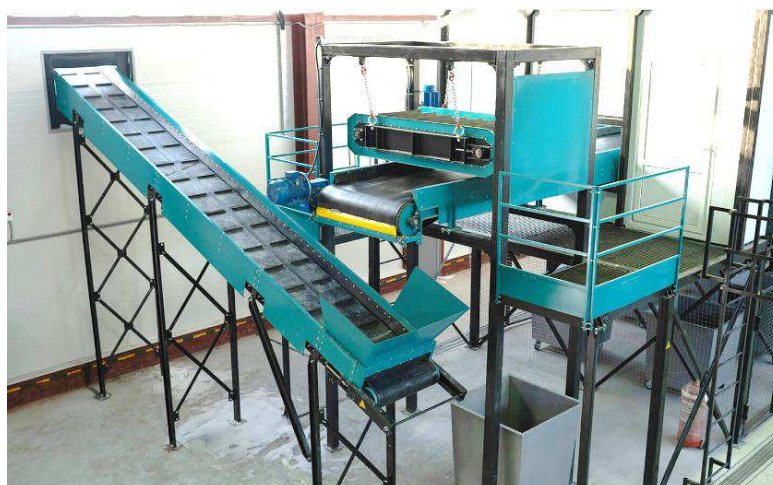
Рисунок 18 – Установка магнитного сепаратора подвешенного типа [20]
