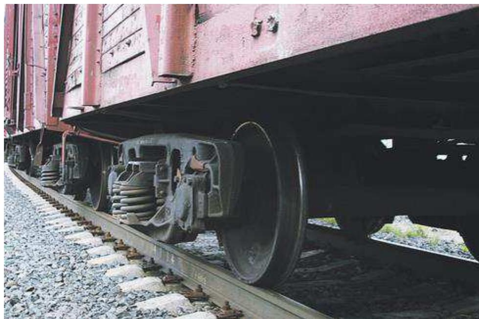
**Рисунок 6 – Трибоконтакт «колесо-рельс»**
