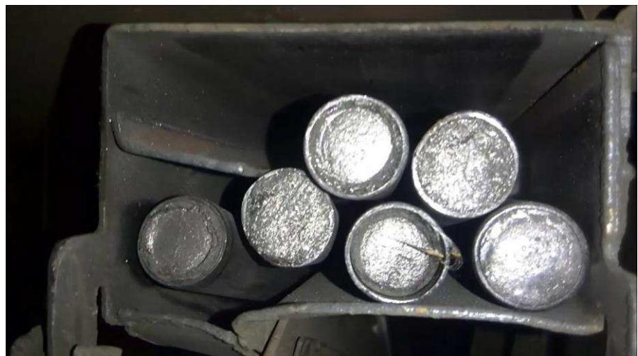
Рисунок 20 – Накопительная часть графитовых стержней
