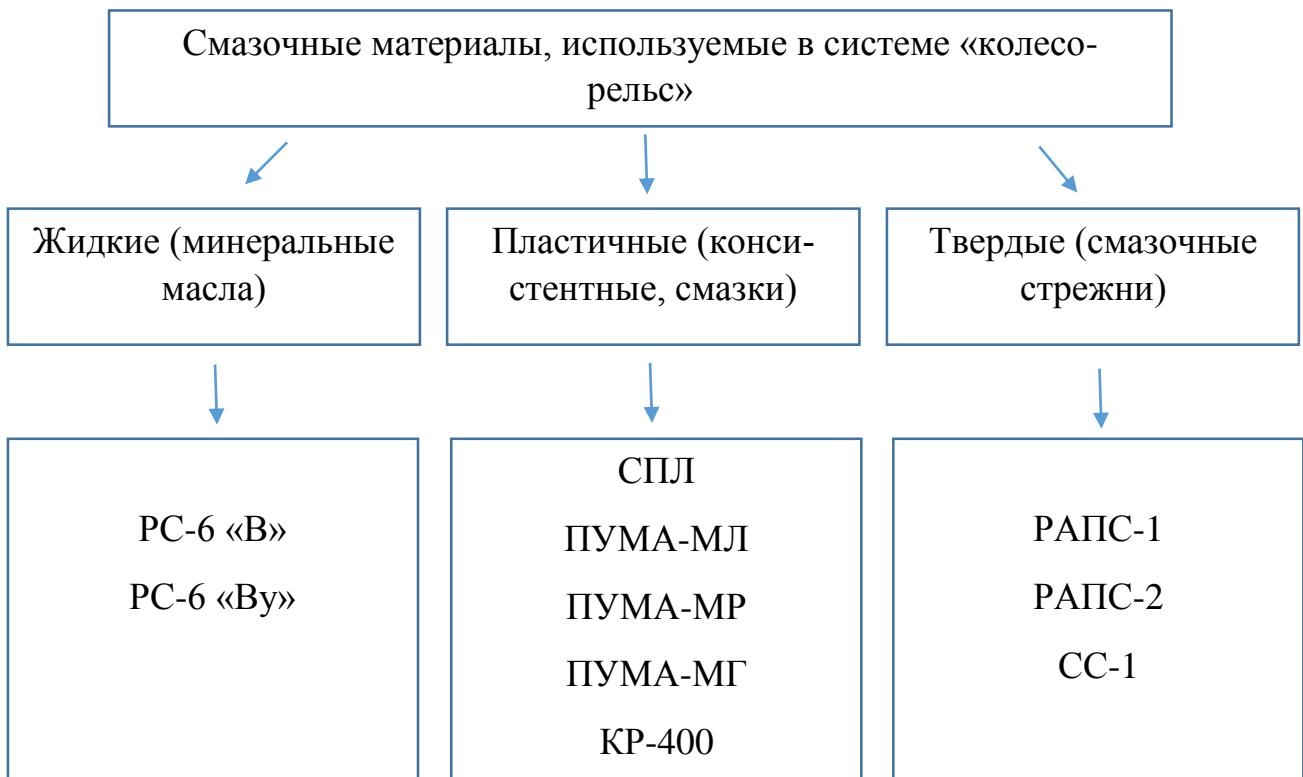
Рисунок 8 – Классификация смазочных материалов для трибоконтакта «колесо-рельс»
