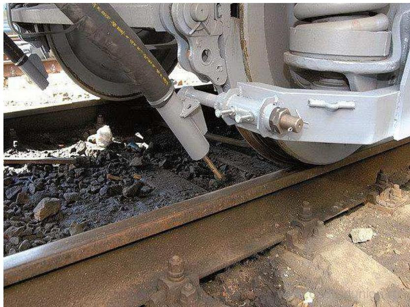
Рисунок 12 – Шланг для подачи смазочного материала
