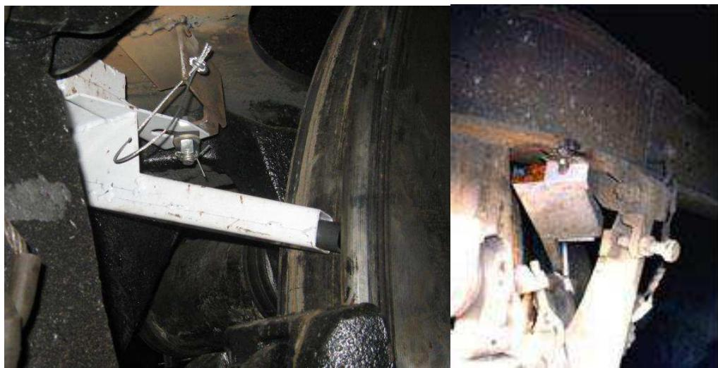
Рисунок 21 – Стержневой гребнесмазыватель
