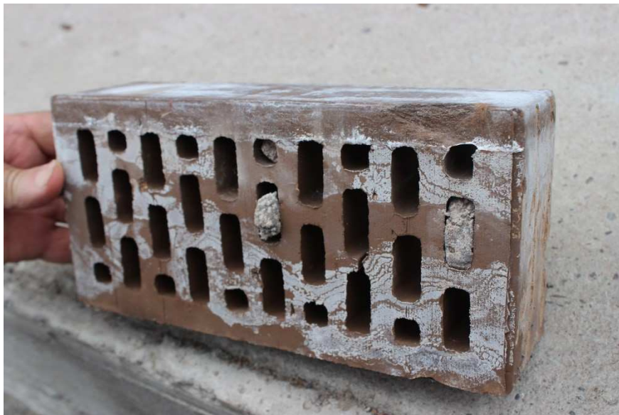
Рисунок 4.2.2 – Изъятие кирпича из массива стены для определения размеров микропор
