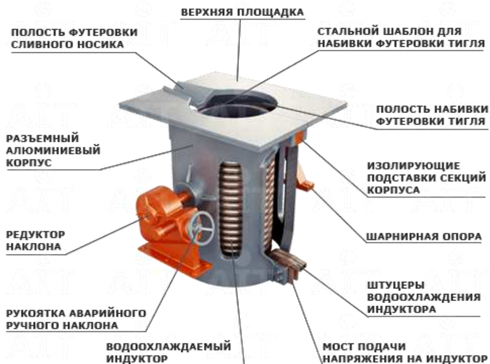
Рисунок 24 – Основные элементы индукционно-тигельной печи фирмы «Inductotherm Group»
