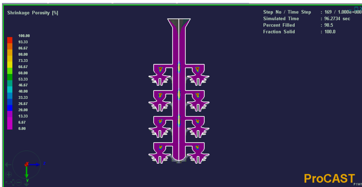
Рисунок 43 – результаты моделирования в программе ProCAST (разрез по оси: YZ)
