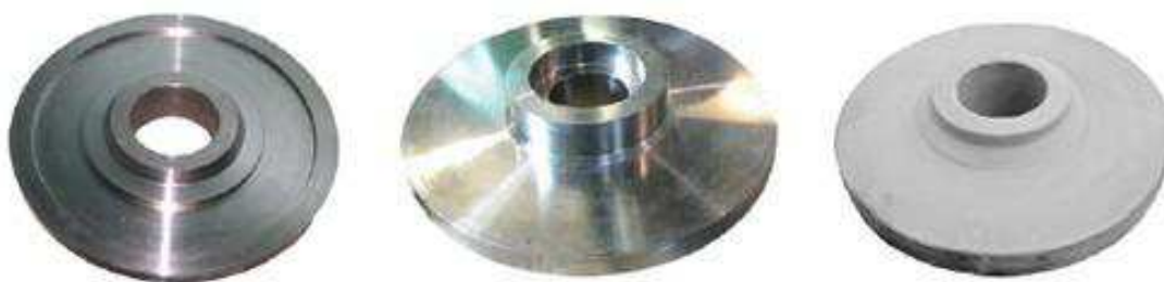
Рисунок 16 – Штамповки дисков ТВД (диаметром 500–600 мм) из сплава ВЖ175-ИД
