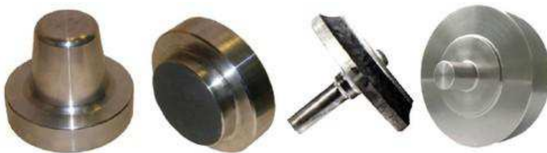
Рисунок 15 – Роторы турбин конструкции «блиск» (диск с валом и лопатками) из сплава ЭП975-ИД для изделий кратковременного действия и вспомогательных силовых установок (ВСУ)
