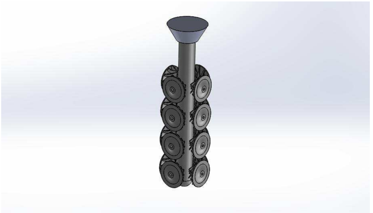
Рисунок 35 – 3D модель блока с элементами литниково-питающей системы (Изометрия)
