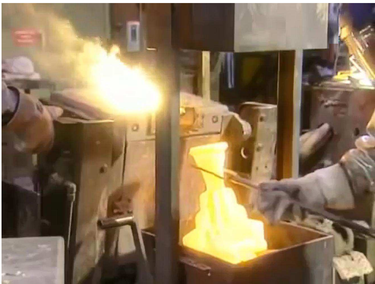
Рисунок 48 – Индукционно-тигельная печь фирмы «Inductotherm Group» объемом 250 кг
