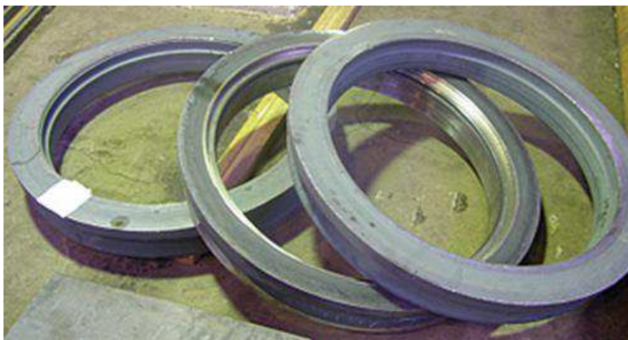
Рисунок 18 – Цельнокатаные кольца (диаметром 840 мм) из сплава ВЖ172
