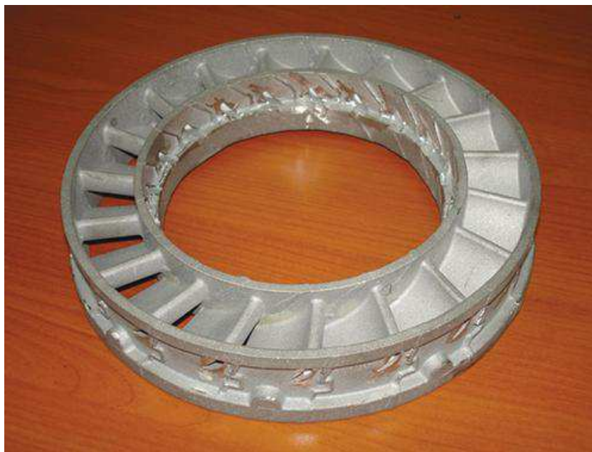
Рисунок 22 – сопловый аппарат двигателя АЛ-31Ф из сплава ВКНА-4УР
