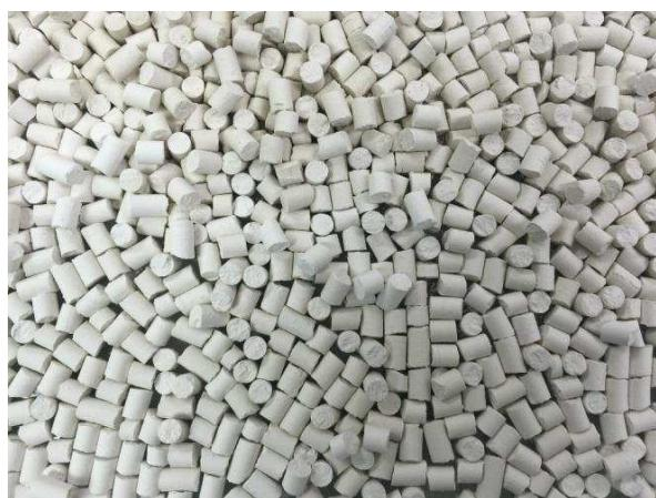
Рисунок 9 – Гранулированный морденит
