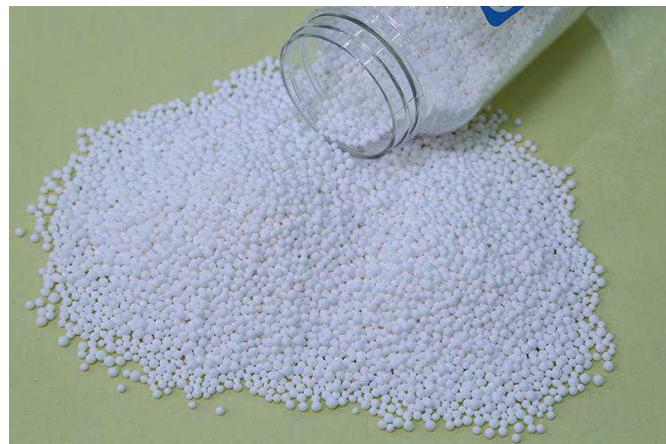
Рисунок 10 – Мелкопористый ионит
