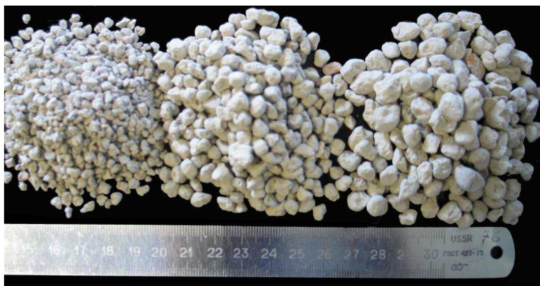
Рисунок 8 – Глинистый сорбент с различным размером гранул
