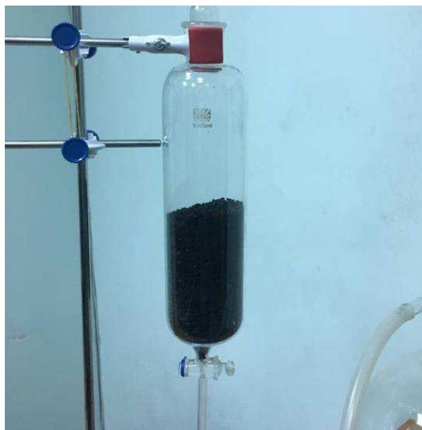
Рисунок 3 – Угольная фильтрующая колонка
