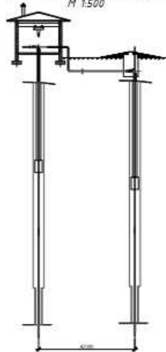
Профиль водозаборного сооружения М 1:500
