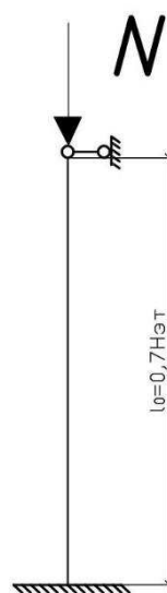
Рисунок 2.16 – Расчетная схема колонны
