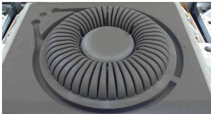
Рисунок 36 –Образец полуформы по Сейатцу-процессу
