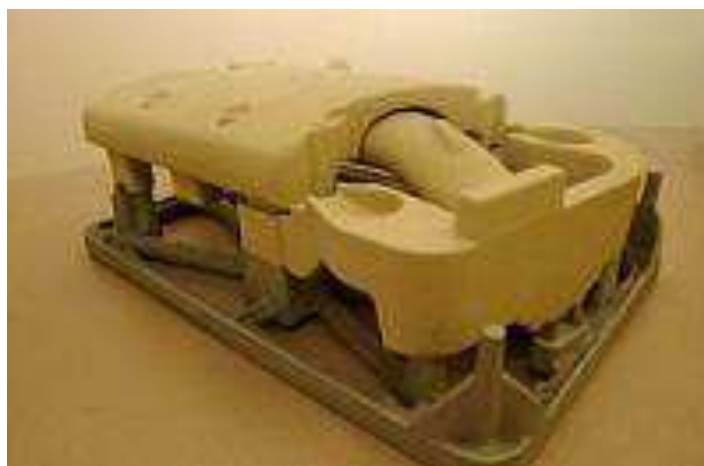
Рисунок 40 – Форма выполненная из связующей системы COLD BOX AMIN
