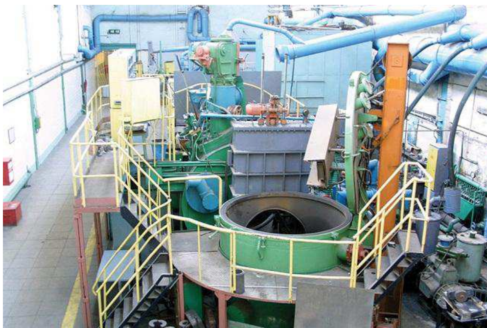
Рисунок 3 – Печь ОКБ-736 (разработка ВИАМ–ВНИИЭТО, 1967 г.)
