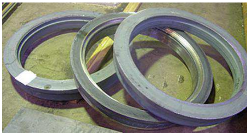
Рисунок 17 – Цельнокатаные кольца (диаметром 840 мм) из сплава ВЖ172
