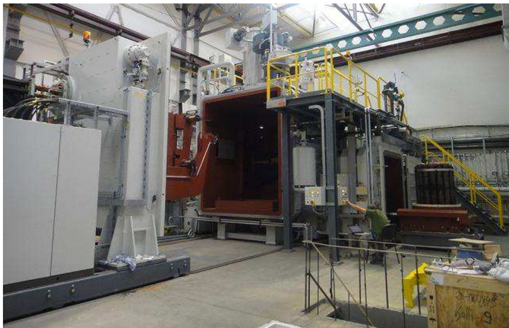
Рисунок 7 – Вакуумная индукционная печь VIM 150 (емкость тигля 650 и 1000 кг)
