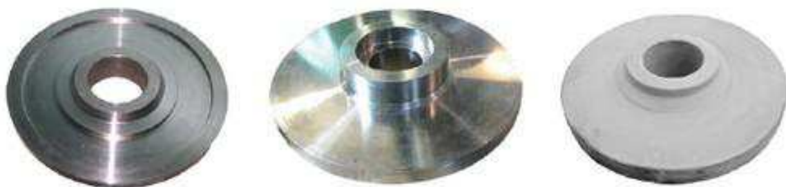
Рисунок 15 – Штамповки дисков ТВД (диаметром 500–600 мм) из сплава ВЖ175-ИД
