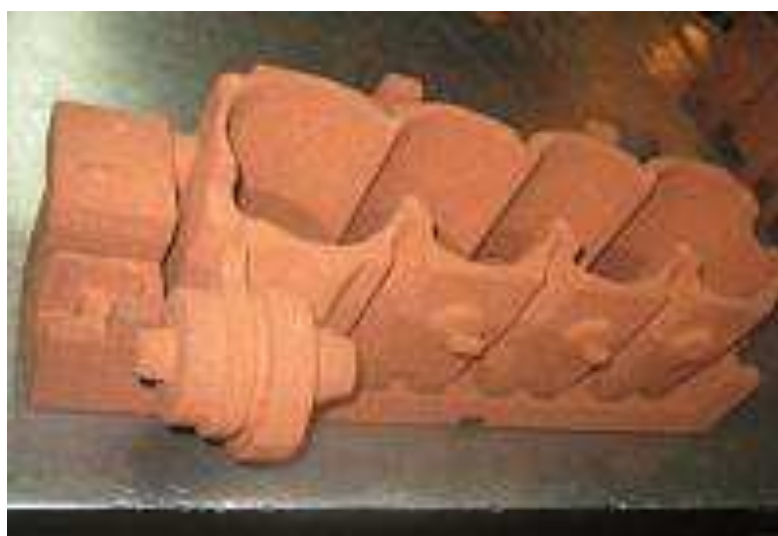
Рисунок 43 –Форма, выполненная из связующей системы Nothox
