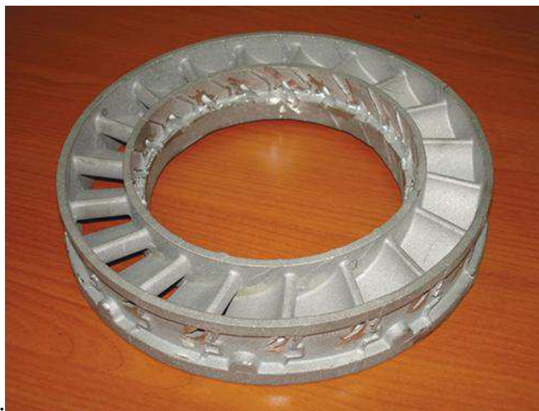
Рисунок 21 – Сопловой аппарат из сплава ВКНА-4УР
