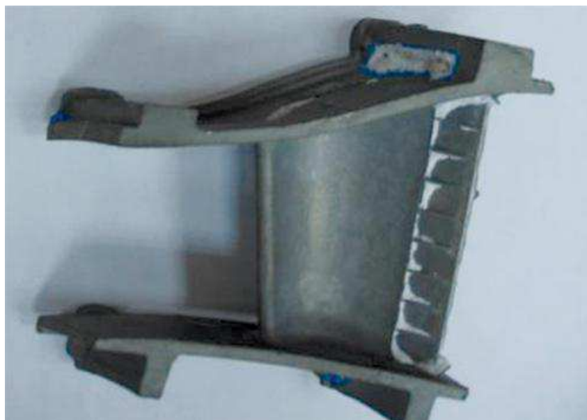
Рисунок 23 – Сопловой лопатка из сплава ВКНА-4У
