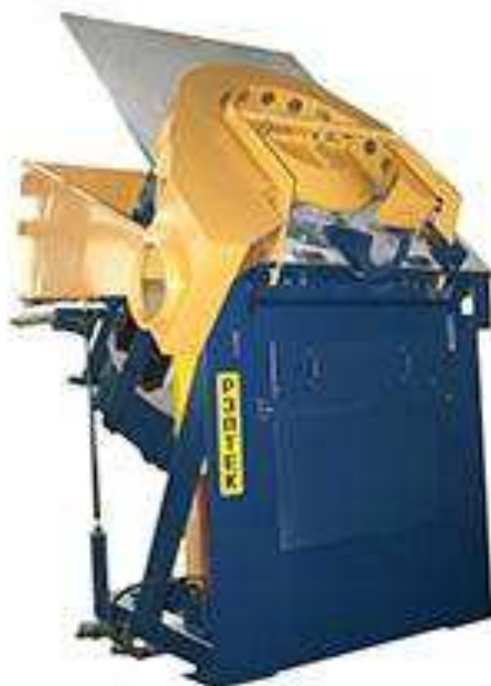
Рисунок 32 – Установка индукционная плавильная РЭЛТЕК
