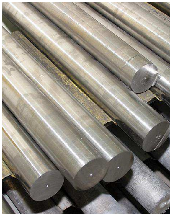
Рисунок 6 – Внешний вид литых прутковых заготовок
