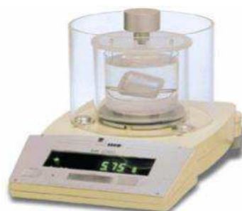
Рисунок 19 – Специализированные весы для определения плотности образцов алюминия методом гидровзвешивания «МК2200»
