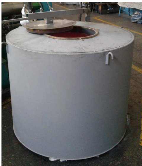
Рисунок 15 – Внешний вид электропечи САТ–0,25
