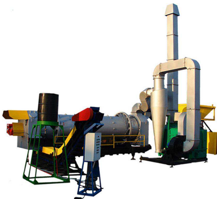
Рисунок 11 – Установка для обезвреживания нефтесодержащих отходов УЗГ-1М
