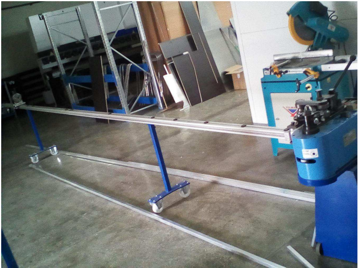
Рисунок 20 – Станок для загибання труб алюміній ЧПУ
