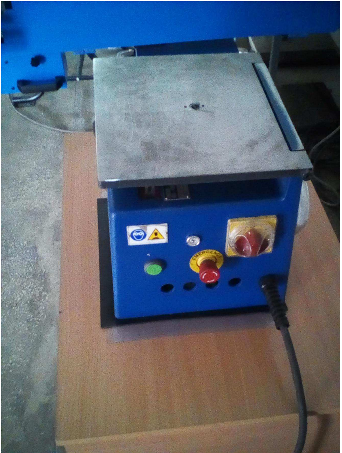
Рисунок 19 – Оборудование для снятия фасок с плоских металлоизделий
