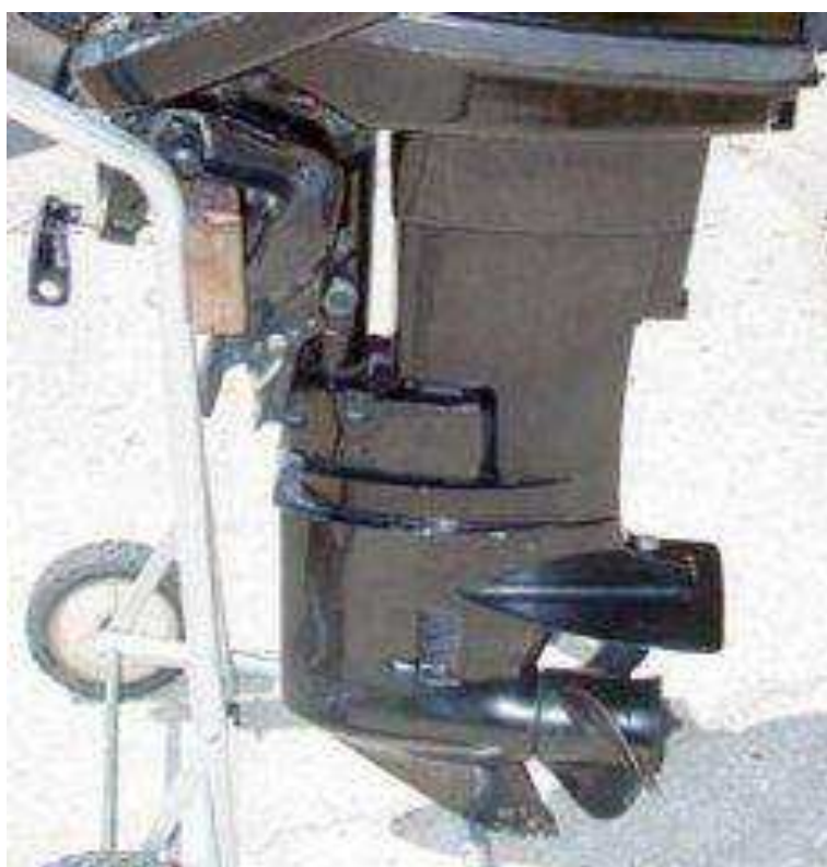
Рисунок 12 – Нижняя часть мотора - дейдвуд
