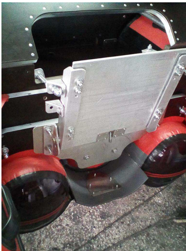
Рисунок 7 – Усиление транцевой плиты, установка двигателя
