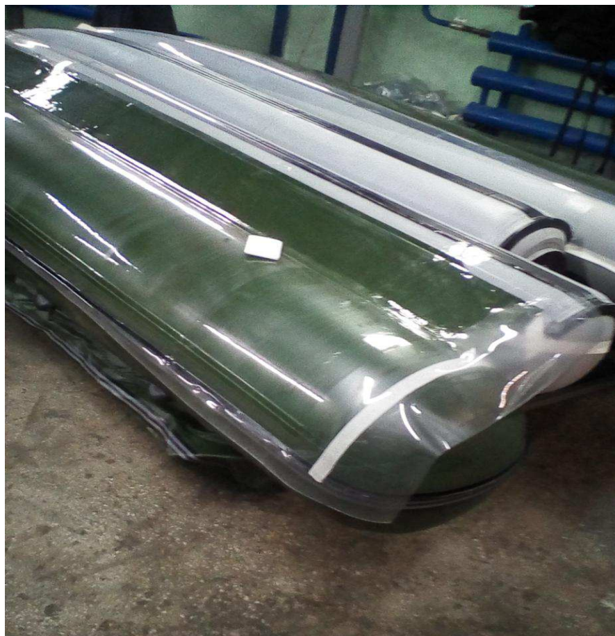
Рисунок 6 – Бронирование днища лодки
