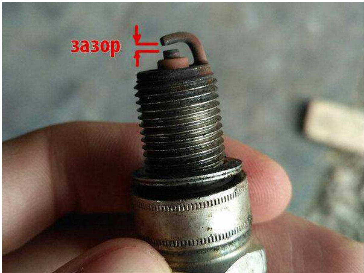
Рисунок 14 – Проверка свечей зажигания
