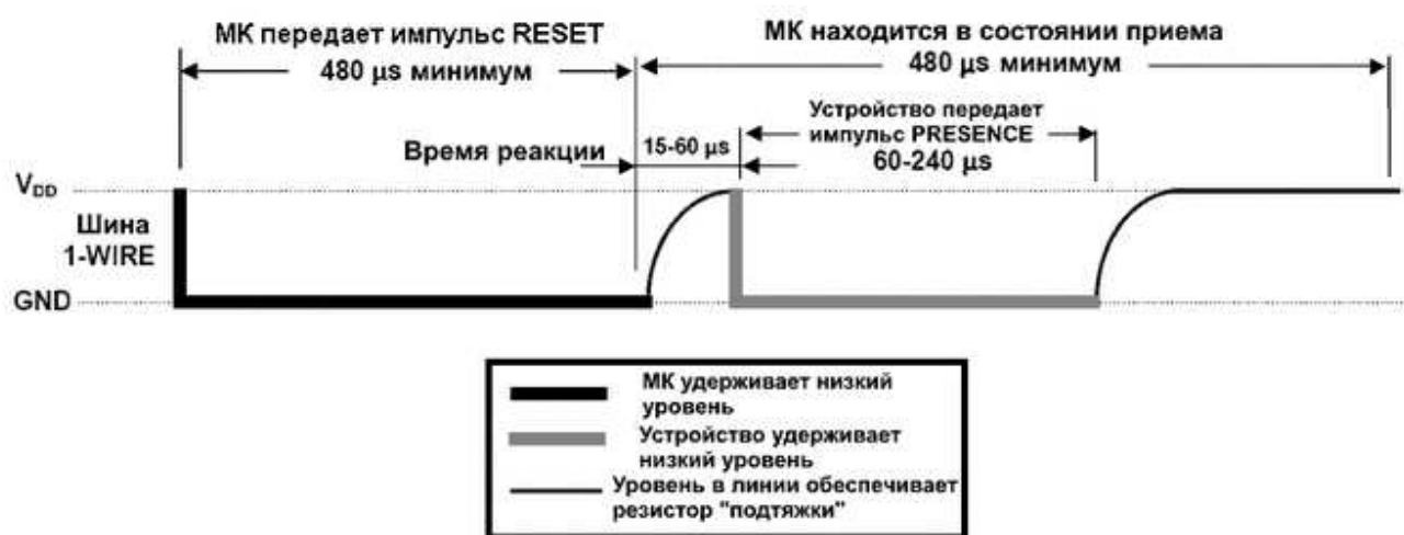
Рисунок 10 — Диаграмма сигналов на шине сети 1-Wire.
