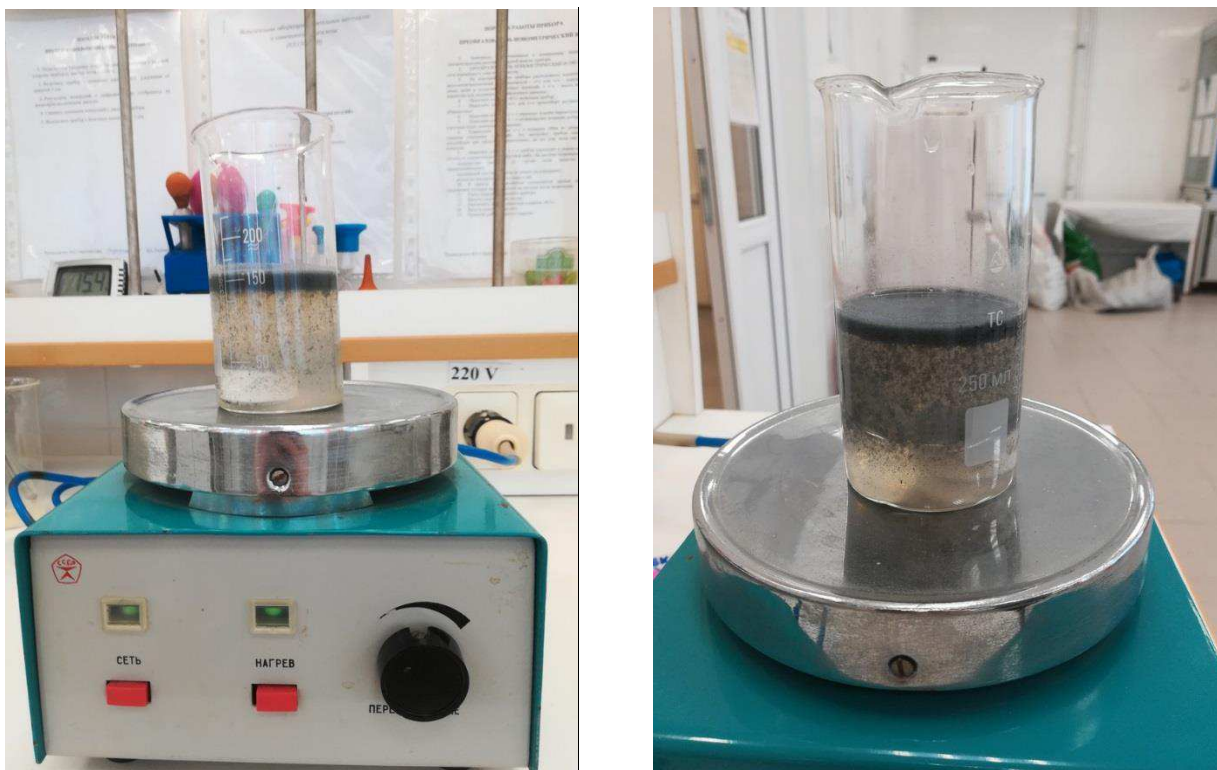
Рисунок 4.2 – Результаты второго этапа эксперимента (фото слева – исходный раствор с добавлением флокулянта Superflock спустя 5 минут, фото справа – спустя 10 минут)
