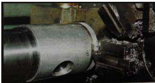
Рисунок 28 – Обработка заготовки на токарном станке с применением ЧПУ
