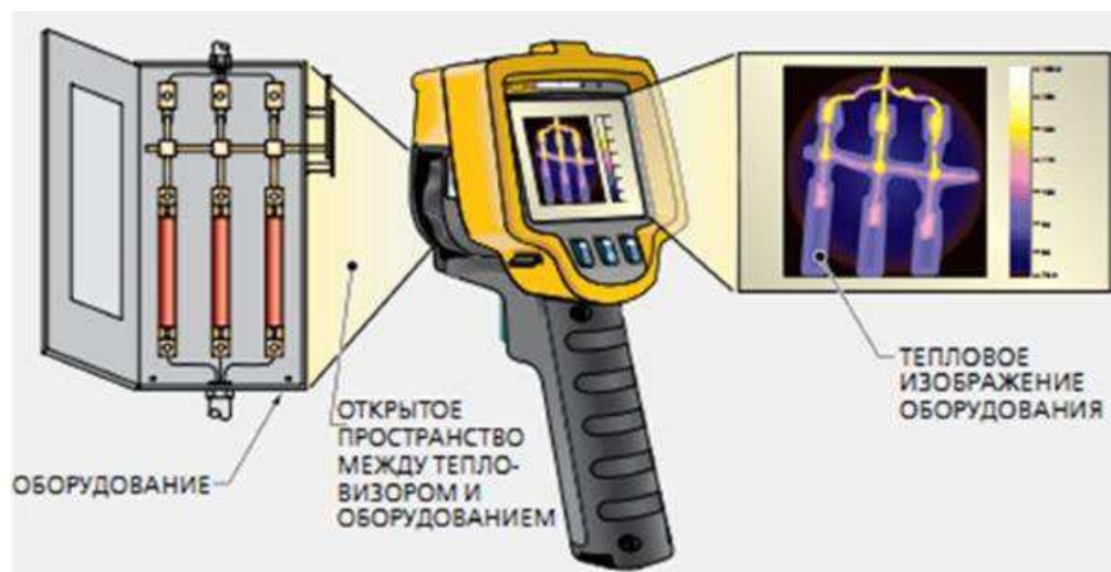
Рисунок 37 – Принцип работы тепловизора
