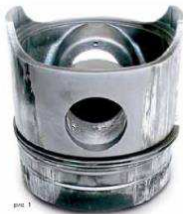
Рисунок 25 – Внешний вид поврежденного поршня с задирами на юбке поршня
