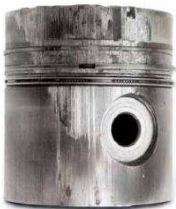
Рисунок 22 – Внешний вид поврежденного поршня дизельного двигателя, вследствие не корректной работы топливной аппаратуры.
