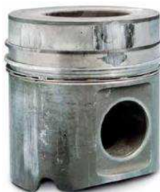
Рисунок 24 – Внешний вид поврежденного поршня
