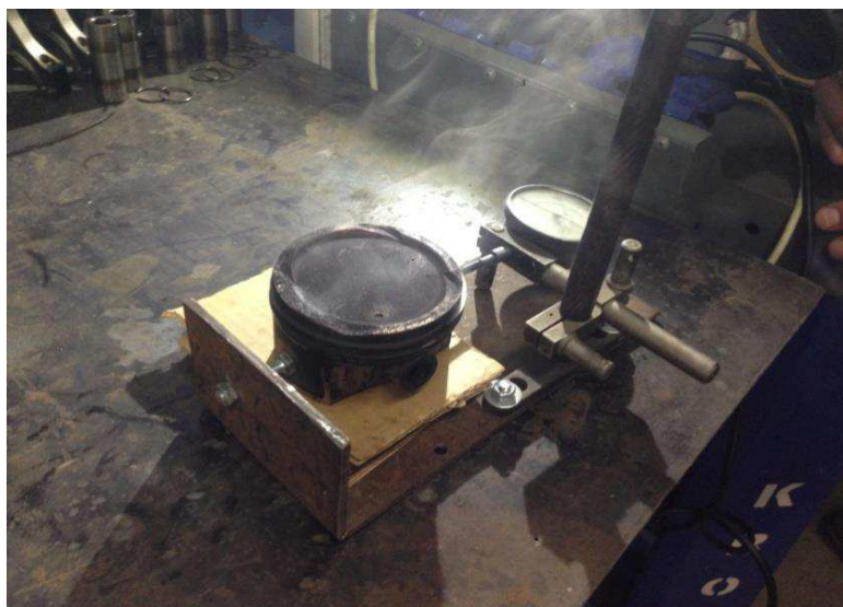
Рисунок 40 – Общий вид стенда для измерения температурной деформации с применением инфракрасного нагрева
