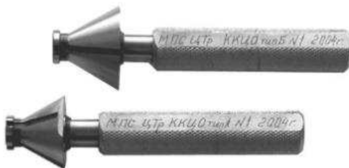
Рисунок 35 – Внешний вид конусного калибра
