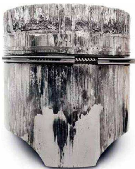
Рисунок 23 – Внешний вид поврежденного поршня, из-за перегрева двигателя
