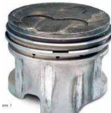
Рисунок 20 – Внешний вид поврежденного поршня, вследствие недостаточного зазора на юбке поршня
