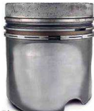
Рисунок 26 – Внешний вид поврежденного поршня из-за повышенного расхода масла
