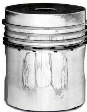
Рисунок 21 – Внешний вид поврежденного поршня, вследствие работы без смазки
