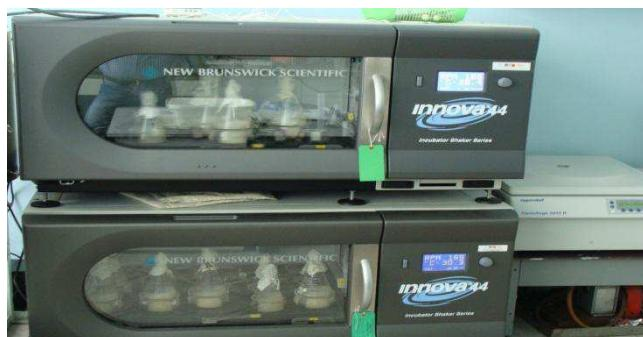
Рисунок 1. - Фото шейкеров-инкубаторов «Incubator Shaker Innova 44 для культивирования бактерий в колбах.
