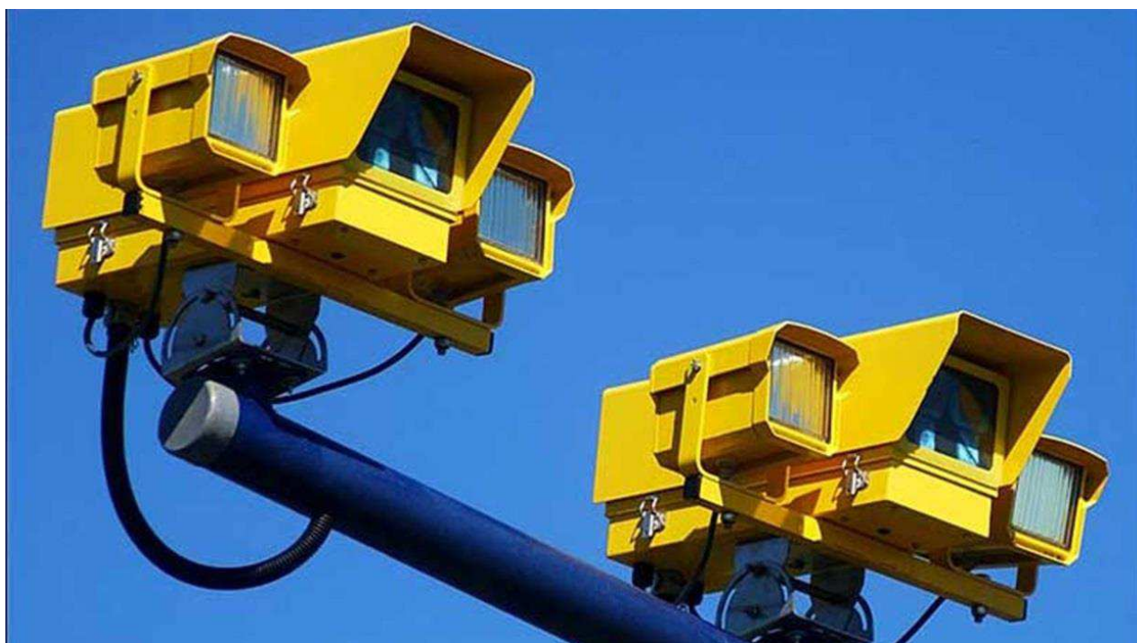
Рисунок 2.27 – Комплекс фиксации нарушений ПДД применяемый в Германии
