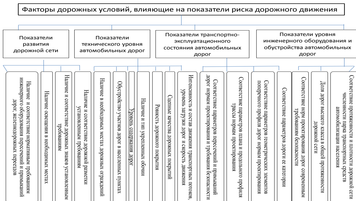
Рисунок 1.6 – Основные группы параметров дорожных условий, оказывающие влияние на показатели риска дорожного движения
