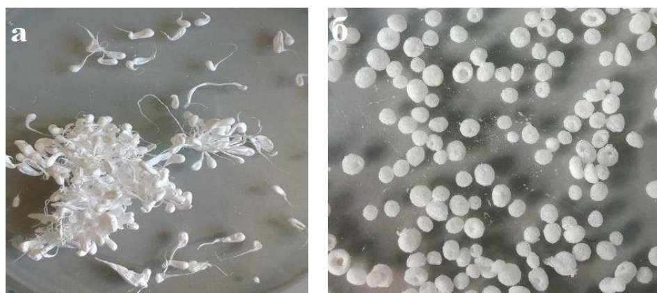
Рисунок 3 – Макрофото гранул на основе П(ЗГБ), без порообразующего вещества (а) и с порообразующим веществом (сахароза)
