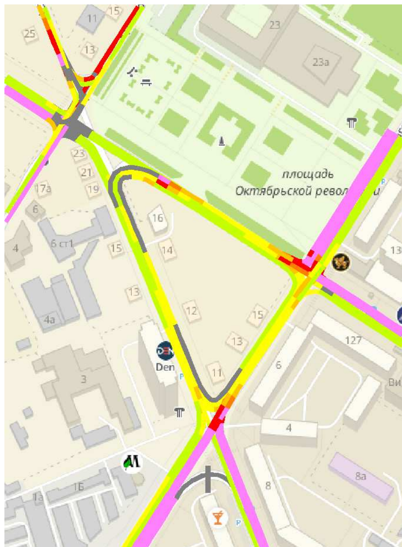
Рисунок 57 – Цветовое отображения состояния транспортных потоков при организации одностороннего движения.
