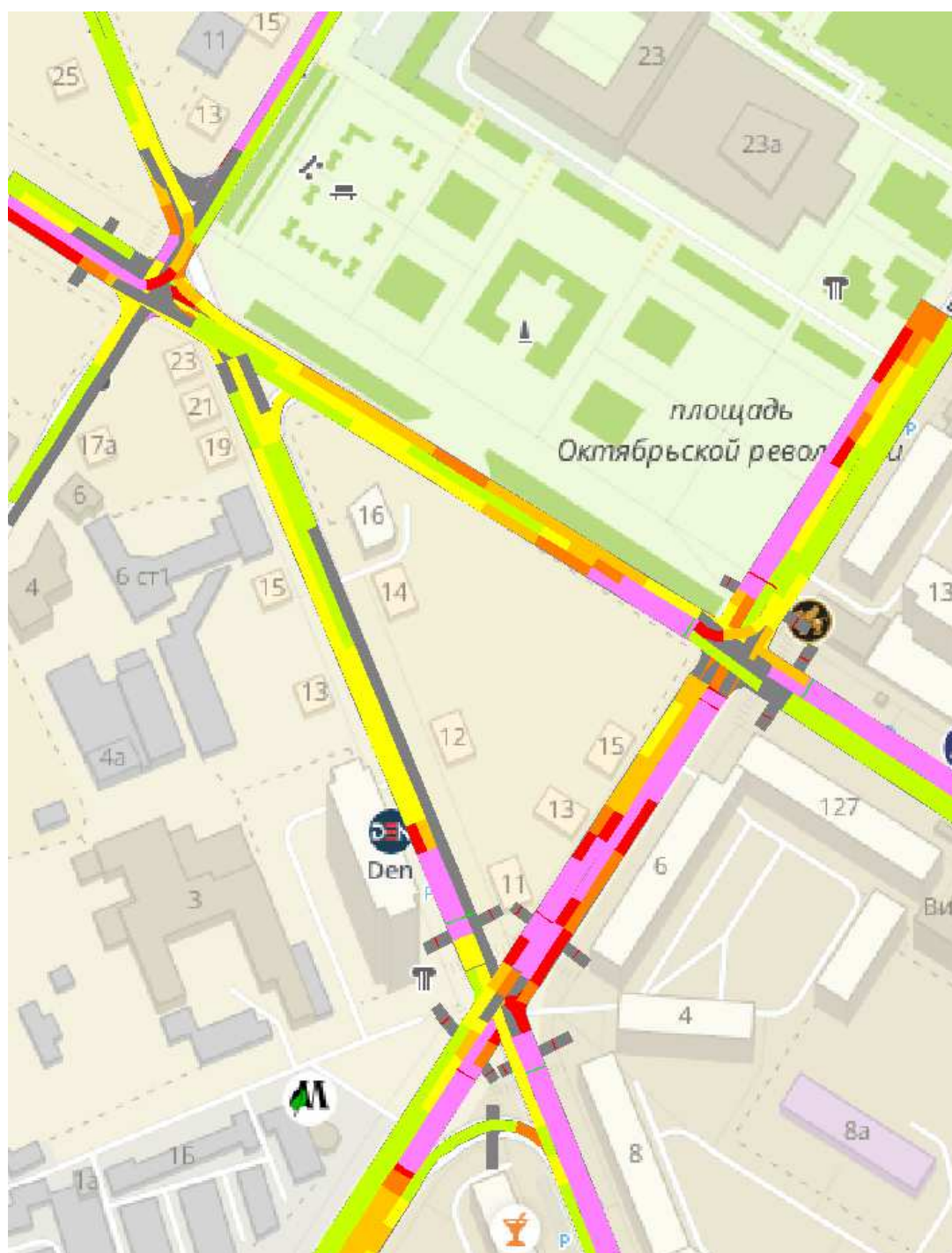
Рисунок 55 – Цветовое отображения состояния транспортных потоков при проектируемом ОДД (разделение движения по времени) на пересечении ул. Ленина - ул. Богомягкова - ул. Кастринская - ул. Красноармейская
