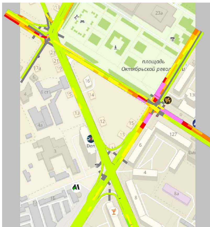
Рисунок 60 – Цветовое отображения состояния транспортных потоков при проектировании эстакады на перспективу 15 лет на участке УДС Центрального района
