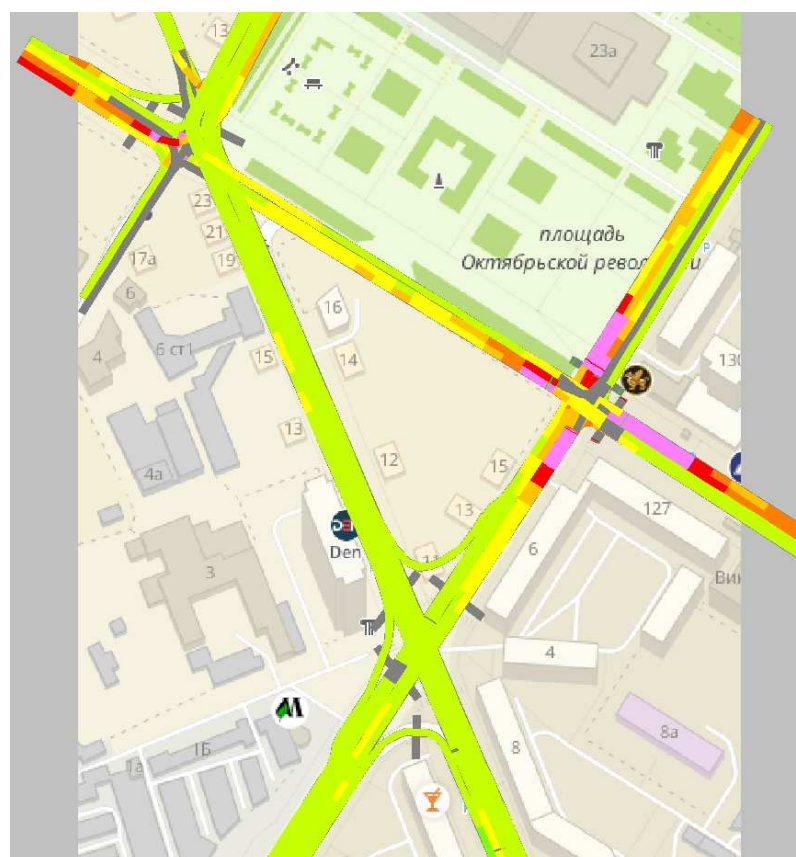
Рисунок 59 – Цветовое отображения состояния транспортных потоков при проектировании эстакады на участке УДС Центрального района
