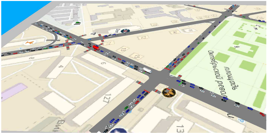
Рисунок 52 – Состояние транспортных потоков при существующей ОДД на пересечении ул. Ленина - ул. Богомяглова - ул. Кастринская - ул. Красноармейская
