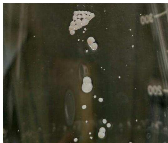
Рисунок 7 – Частицы, полученные эмульсионным методом из ПЗГБ
