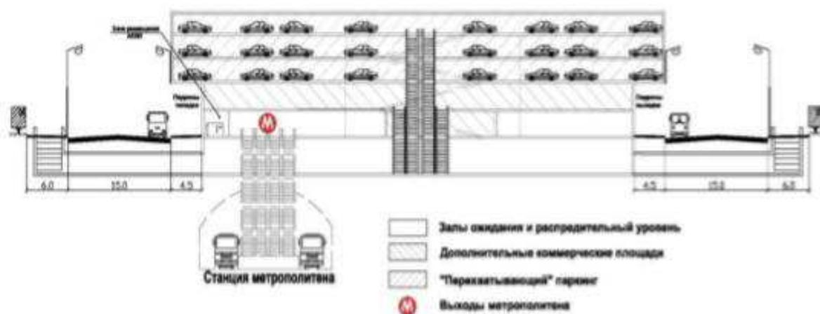
Рисунок 2.4 – Разрез многоуровневого пересадочного комплекса в ТПУ
