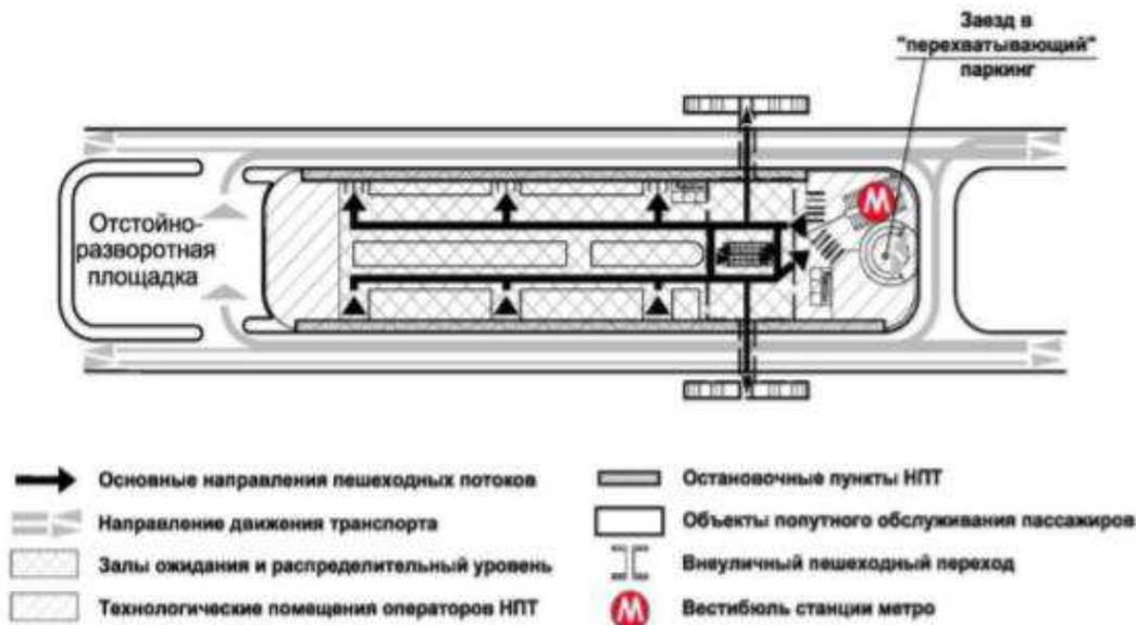
Рисунок 2.3 – Принципиальная схема планировочного решения распределительного уровня ТПУ
