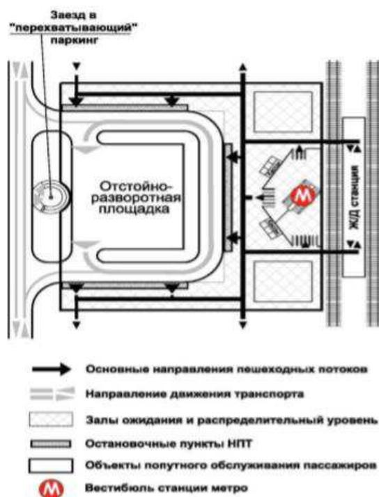
Рисунок 2.6 – Вариант планировочного решения ТПУ агломерационного значения с пересадочным комплексом берегового типа
