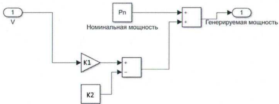
Рисунок 3.2 – Экспериментальная модель модель мини ГЭС, где V – скорость течения реки, м/с; P_n – номинальная генерируемая мощность мини-ГЭС, кВт; K_1, K_2 – коэффициенты линейной зависимости генерируемой мощности от скорости течения реки, зависящие от скоростной характеристики генератора мини-ГЭС
