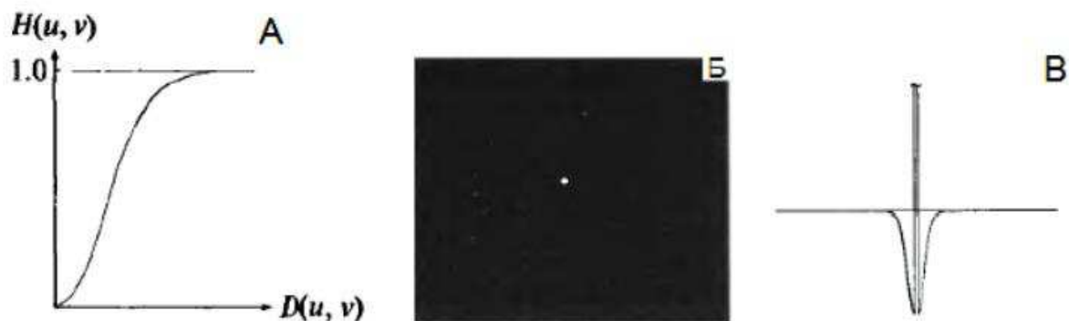
Рисунок 11 – А – радиальный профиль передаточной функции высокочастотного гауссова фильтра, Б – функция высокочастотного гауссова фильтра в пространственной области, В – профиль яркости пространственной функции фильтра
