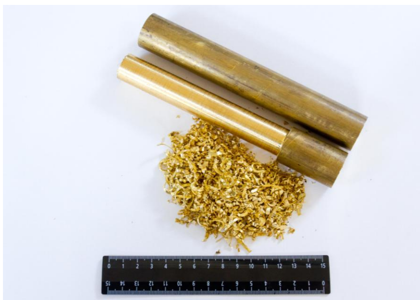
Рисунок 1 – Вид прутка и образующейся стружки после токарной обработки
