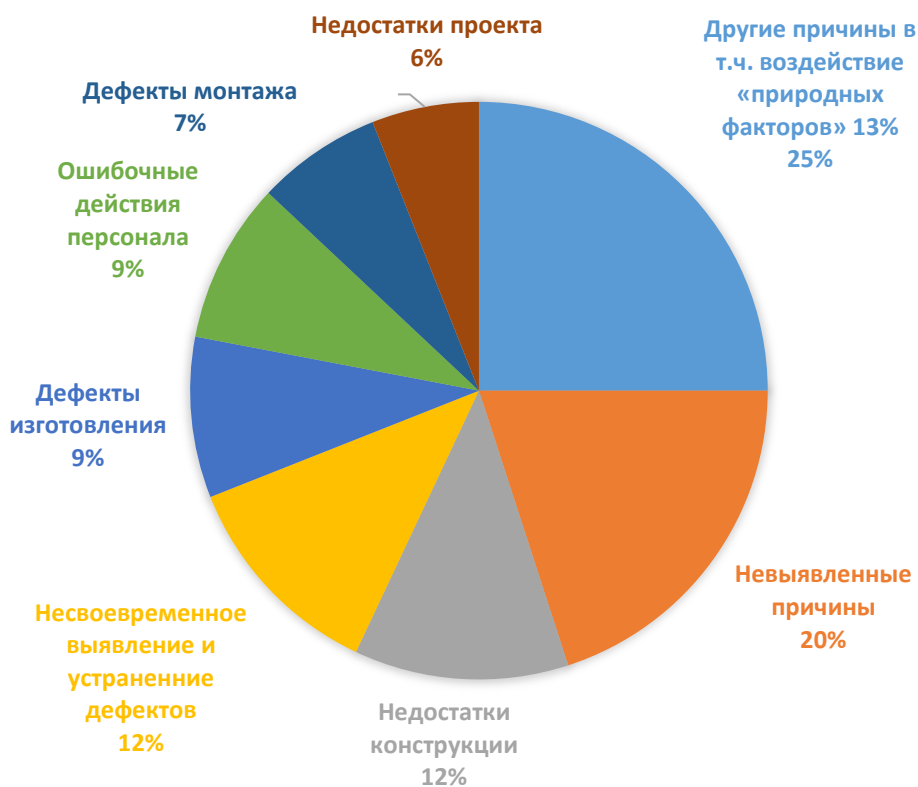
Рисунок 1 – Основные причины аварий на электрических станциях с установленной мощностью 25 МВт и выше
