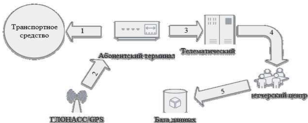
Рисунок 4 – Работа системы спутникового контроля транспорта
