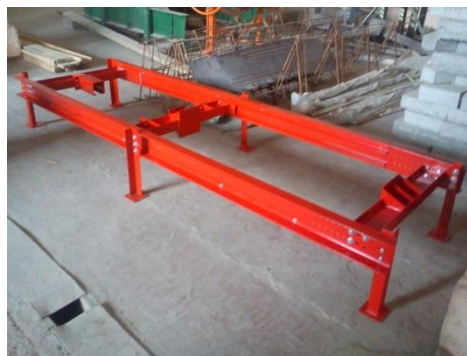
Рисунок 2. Установка для испытаний деревянных стержней на сжатие, растяжение, устойчивость.
