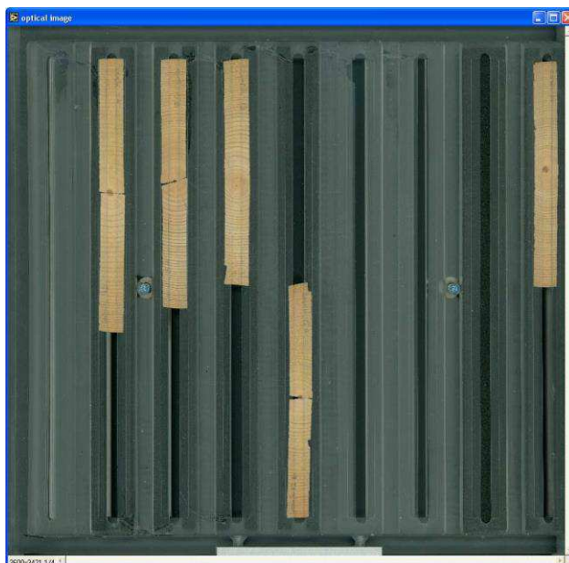
Рисунок 4 – Образцы древесины, установленные в автосэмплер ITRAX сканера.
