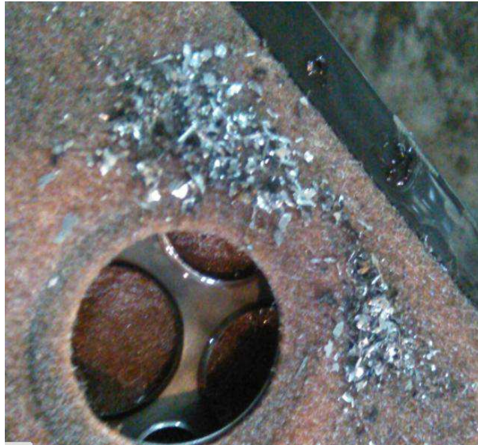
Рисунок 2.3 – Металлическая стружка на фильтре коробки передач
