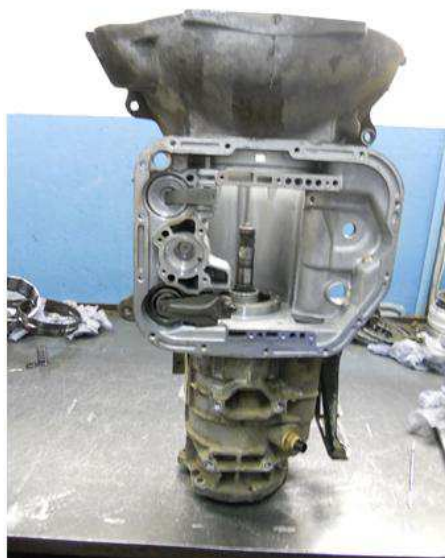
Рисунок 2.20 – Прикручиваем корпус овердрайва к основному корпусу
