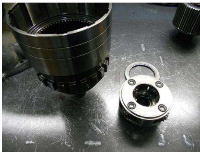
Рисунок 2.16 – Установка планетарной передачи в корпус овердрайва
