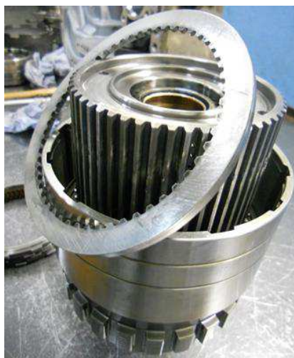
Рисунок 2.17 Сборка фрикционов овердрайва
