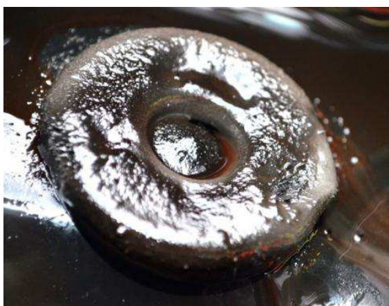
Рисунок 2.2 – Металлическая «стружка» на магните поддона
