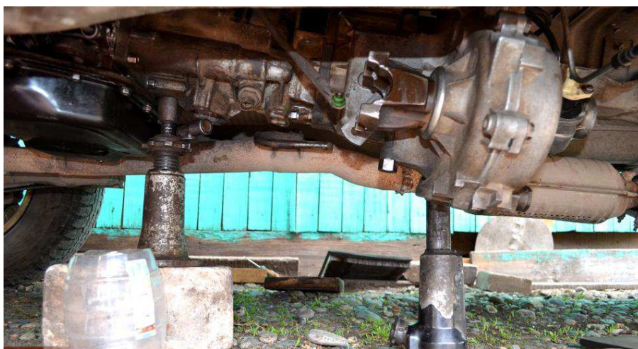
Рисунок 2.1 – Снятие раздаточной коробки передач
