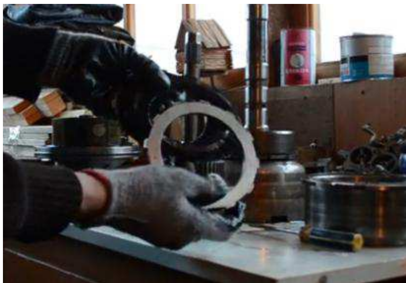
Рисунок 2.13 – Следы перегрева на фрикционе
