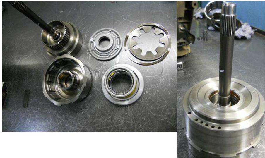
Рисунок 2.22 – Сборка передней передачи
