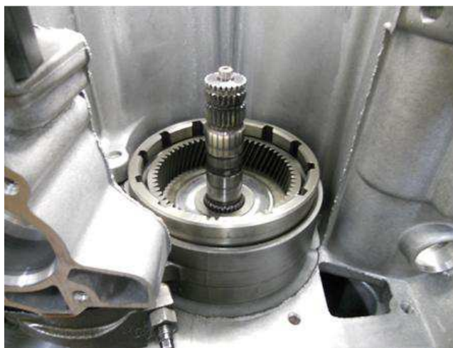
Рисунок 2.21 – Сборка обгонной муфты
