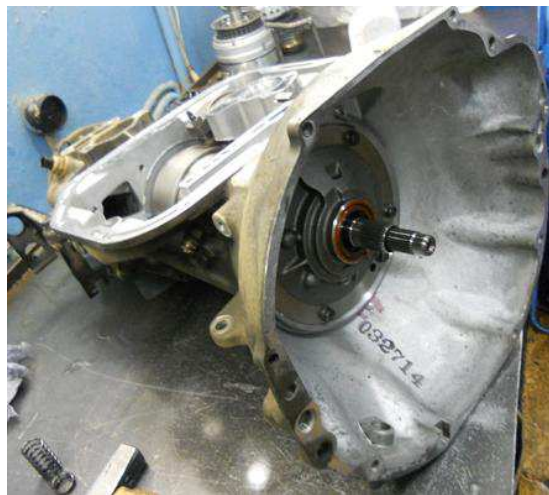
Рисунок 2.23 – Установка штока паркинга
