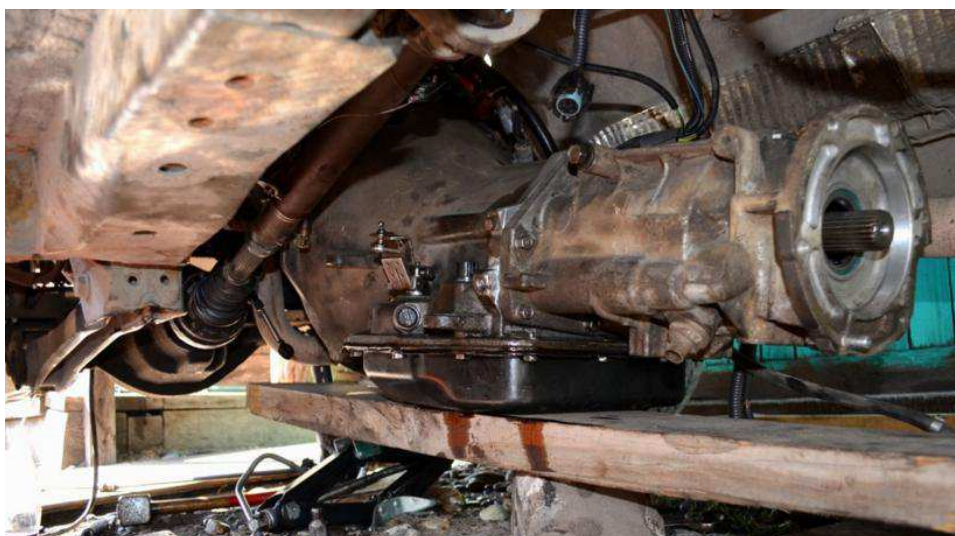
Рисунок 2.6 – Снятие коробки передач из под автомобиля
