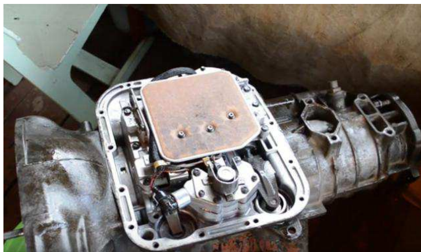
Рисунок 2.7 – Снятие поддона и фильтра
