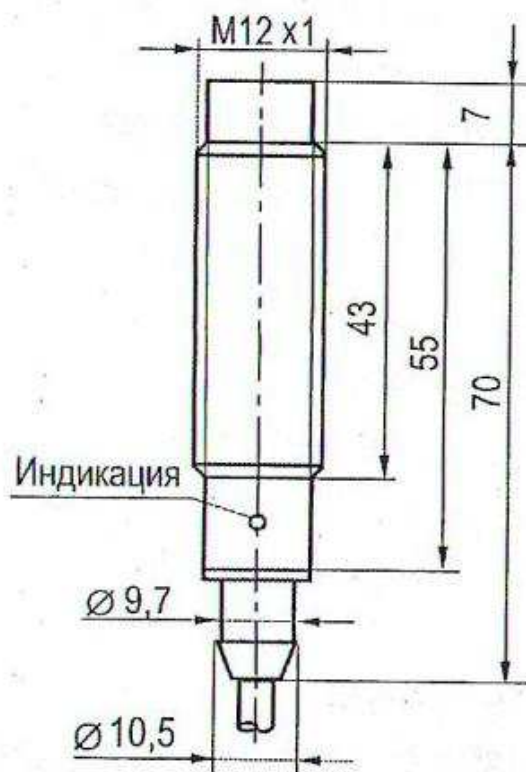
Рисунок 9.4 – Габаритный чертеж индуктивного датчика
