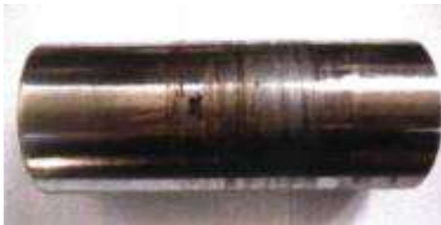
Рисунок 32– Поверхность вала после испытания материала УГЭТ-МФ
