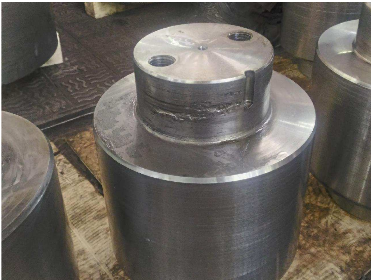
Рисунок 57– Поврежденные пальцы кинематики РК
