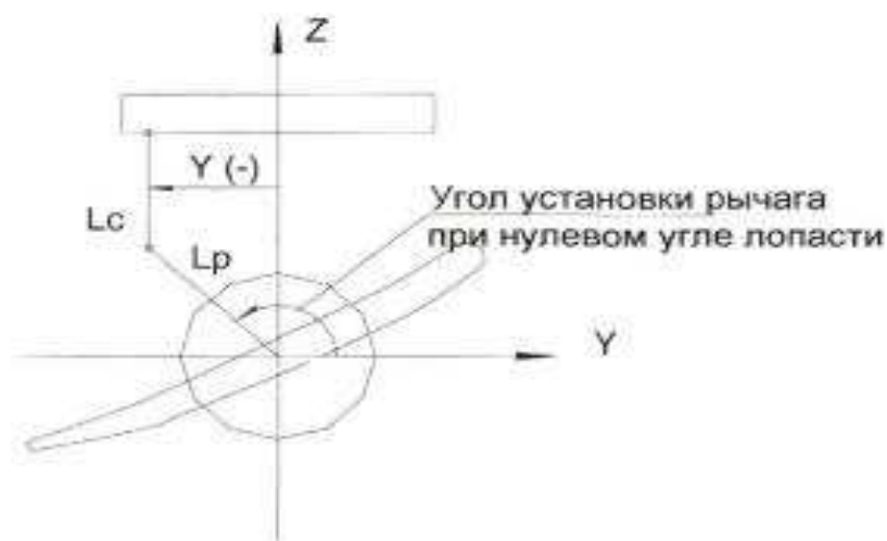
Рисунок 40 – Расчетная схема кинематики поворотнолопастного РК
