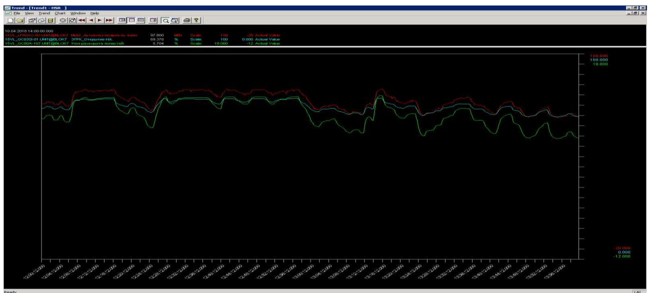
Рисунок 56– Перемещение лопастей гидротурбины ст. №15 в дневной период
