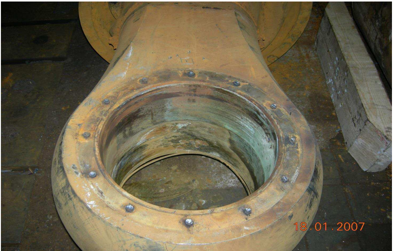
Рисунок 50– Повреждение бронзофторопластового подшипника проушины РК ст. №16
