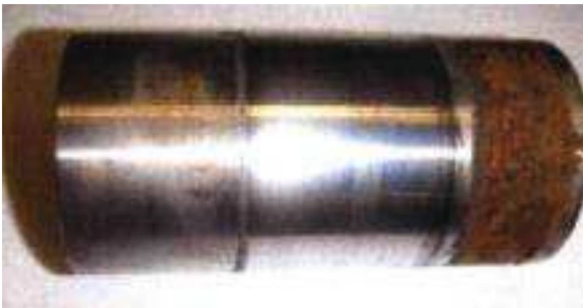
Рисунок 36– Поверхность вала после испытаний материала УСЭК
