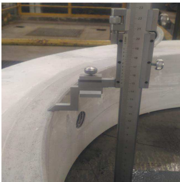
Рисунок 62 – Доработка запорного кольца
