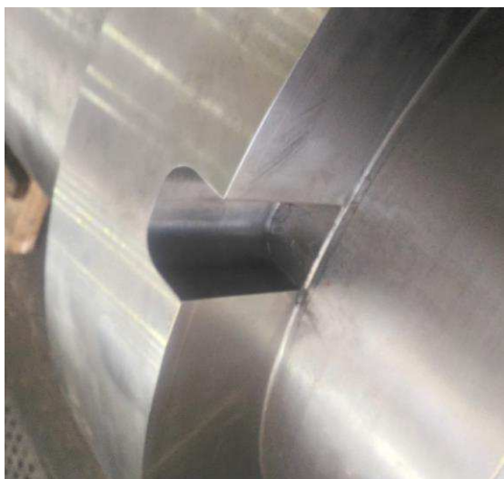
Рисунок 60 – Доработка штока РК
