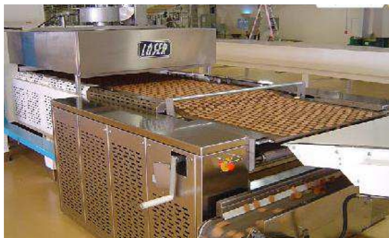
Рисунок 3.5 – Макет полуавтоматической установки для производства отсадного печенья без начинки
