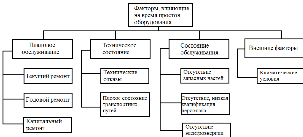
Рисунок 16 – Классификация факторов, влияющих на простои оборудования
