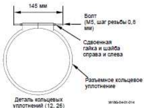
Рисунок 3.6.3 – Смещение/установка кольцевого уплотнения в ковш
