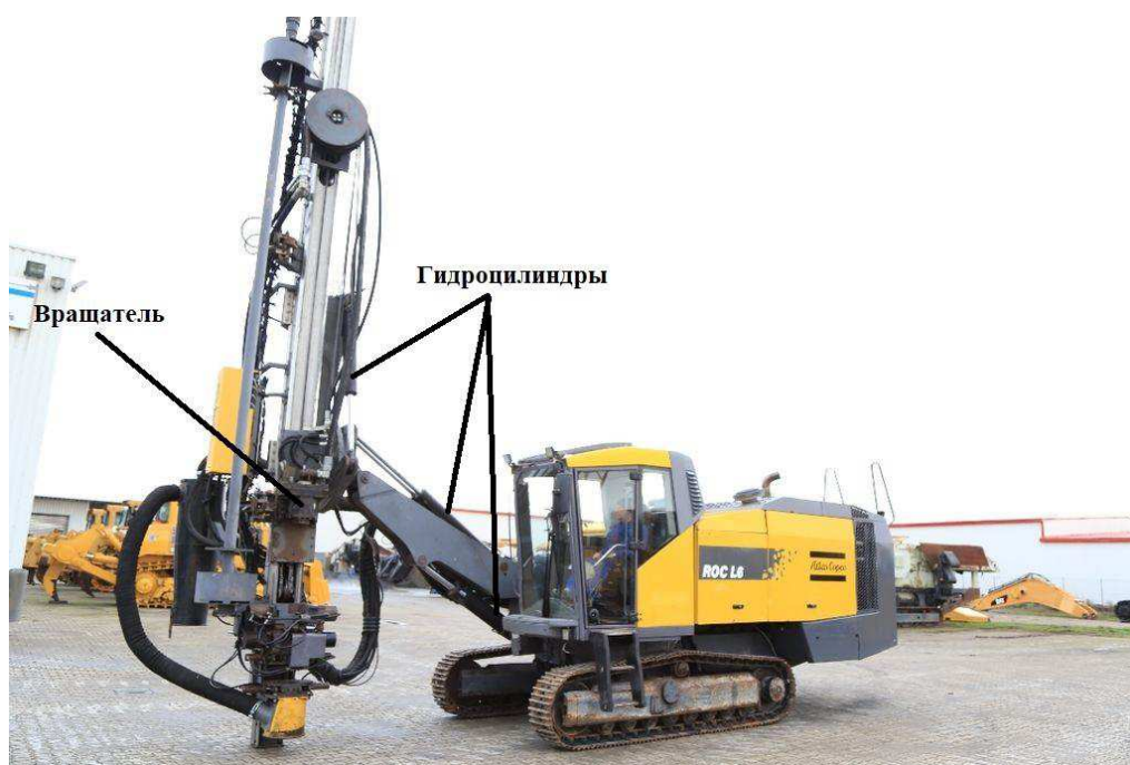
Рисунок 2.46 – Система буровой стрелы
