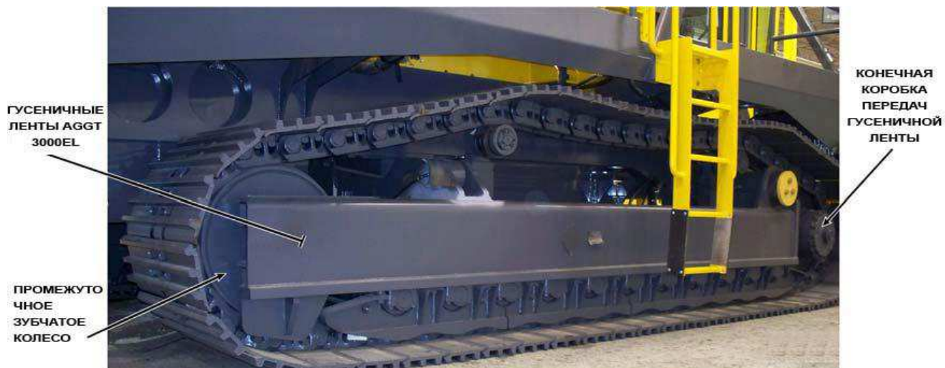
Рисунок 2.29 - Основные узлы ходовой части установки
