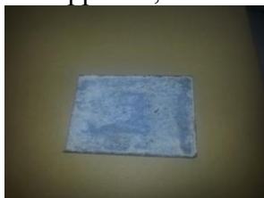
Рисунок 6 – образец после ускоренных коррозионных испытаний
