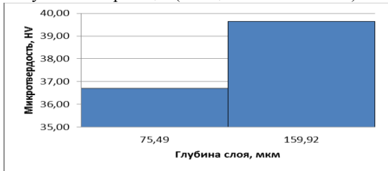
Рисунок 10 – Оразец 2 (толщина слоя 210 мкм)
