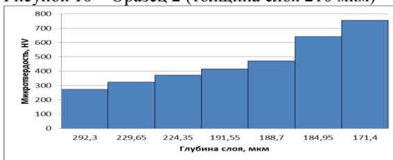
Рисунок 12 – Стальная подложка, зависимость микротвердости, от глубины
