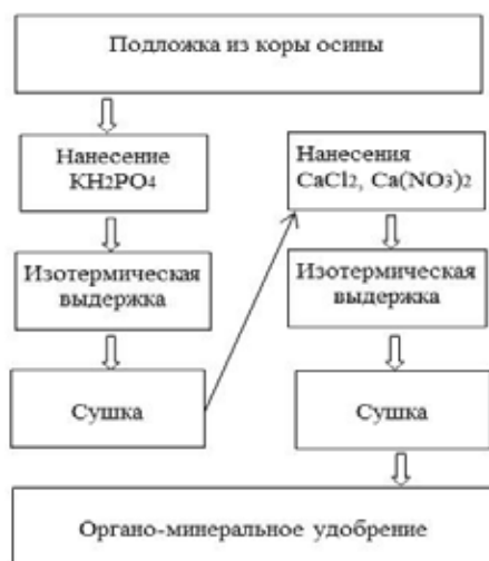
Рис. 1. Схема получения органо-минеральных удобрений на основе коры осины
