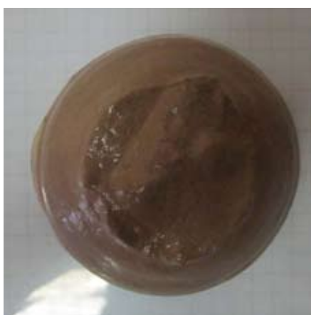
Рис. 1. Образец пастообразных хвостов в процессе растекания с отношением Т:Ж=70:30 при концентрации ПАА 1,0 %
