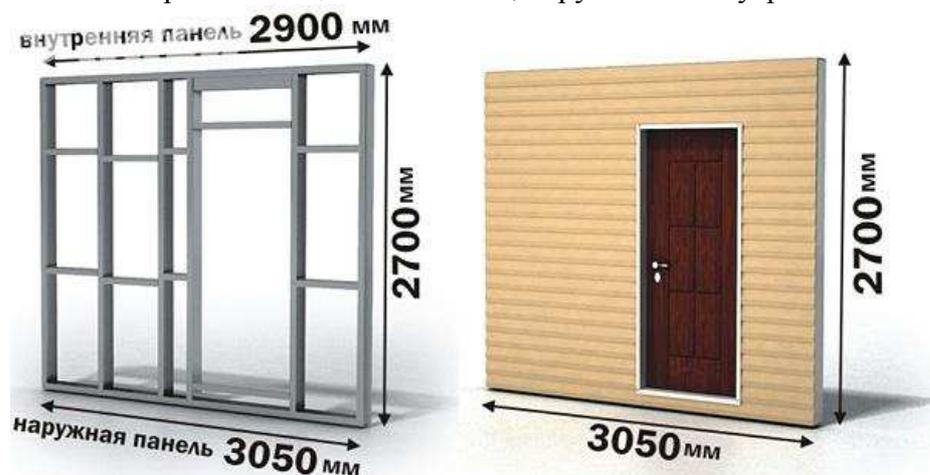
Рисунок 2 – вариант исполнения стеновой панели с дверным проемом
