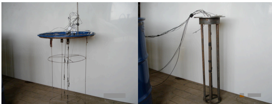
Рис. 4. Блок датчиков экспериментальной установки для измерения температуры во внутреннем объеме бочки
